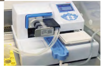
Für das Wirkstoff-Screening wurden automatisierte Hochdurchsatz-Pipetteinheiten eingesetzt. (© Dr. Viktoria Marquardt, David Pauck / Universitätsklinikum Düsseldorf)
